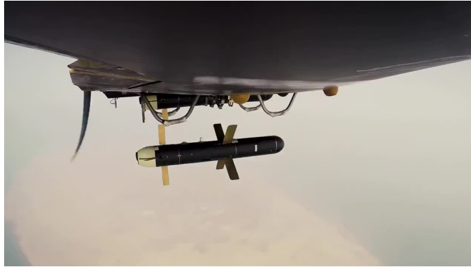
رها سازی بمب هوشمند از پهپاد شاهد-141 که نمونه موتور ملخی پیستونی مقیاس 40 درصد است
