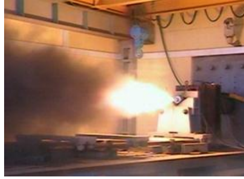
Şekil 5 Yakıt Geliştirme Statik Ateşleme Testi
