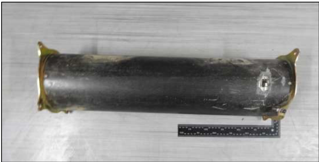
Figure 5. IRN-05 Боеголовка з запобіжником
