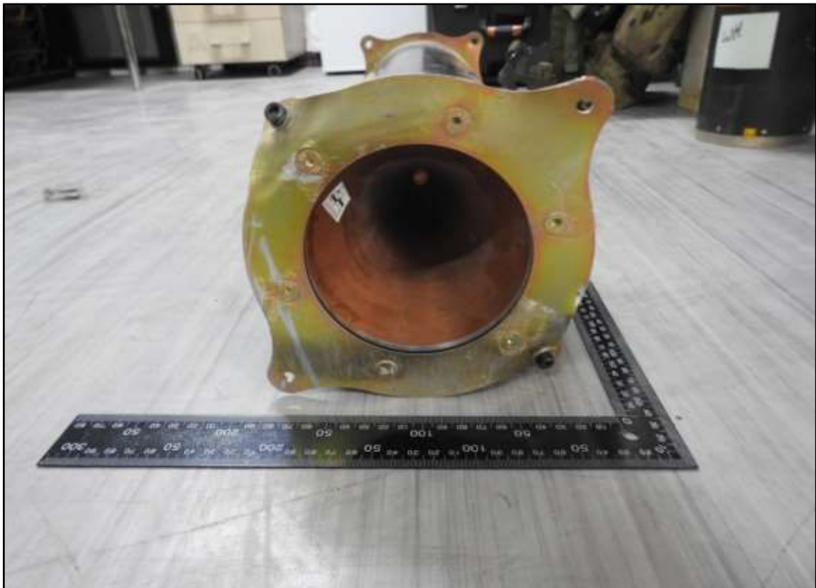
Figure 6. IRN-05 боєголовка з мідним конусом для формуючого заряду
