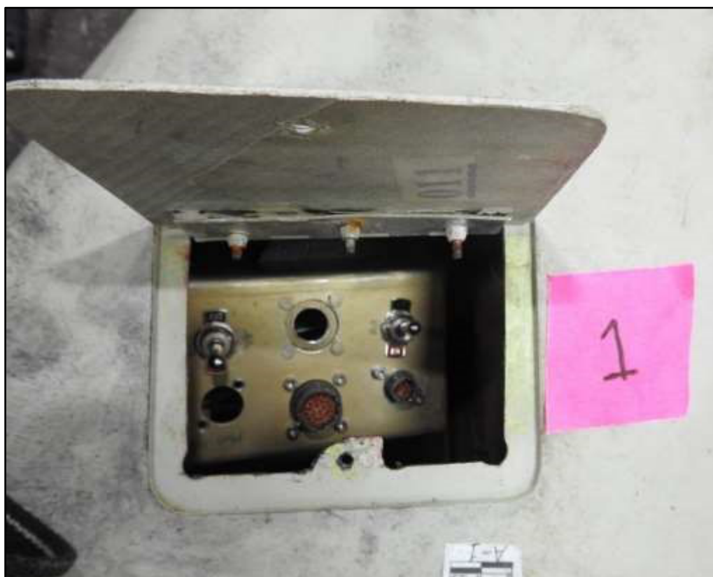
Figure 9. Panel 1, Панель 1 (пристрій блоку живлення)
