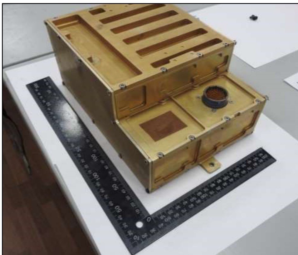
Figure 13 Flight Control Unit. Блок упр польотом
