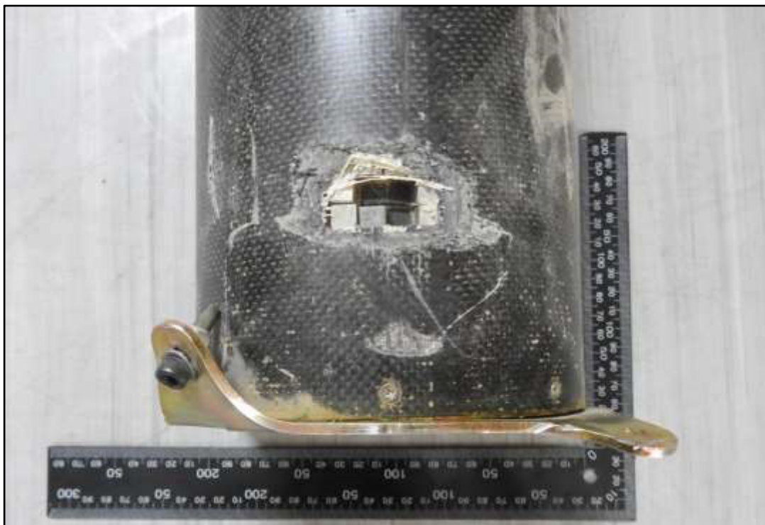
Figure 7. IRN-05 уражаючі елементи в боєголовці (кубики 7мм ребро)
