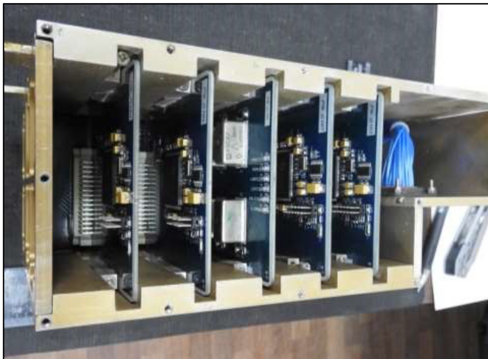
Figure 14. Internal FCU, contain five bespoke PCBs. Блок інерційного контролю
