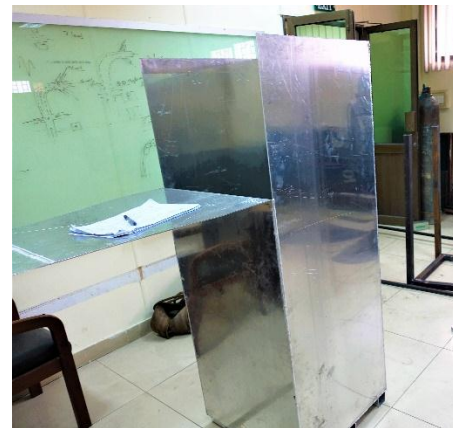
Fig. 7. Outlet Plenum
